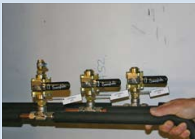
Ventilene får en helt annen utforming enn hva vi er vant til på grunn av de høye trykkene.
