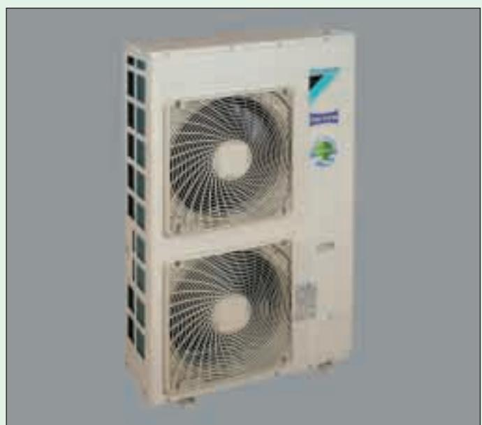
Test av de nye Daikin Sky-Air Super Inverter luft/luft varmepumpe viser varmefaktor (COP) så hög som 6,0 som varmepumpe og kuldefaktor 5,3 som air-conditioning maskin. Disse høye COP verdiene oppnås ved 39% dellast og understreker energieffektiviteten til denne nye produktserien. Selv ved fullast (som normalt vil ha relativt kort driftstid) er COP hele 3,7 som varmepumpe.
