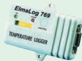
simpelt trykk på loggeren. Har grenseverdiene vært overskredet, vil en rød diode blinke, hvis ikke blinker en grønn. Alle data kan utskrives via loggerens Windows software eller overføres til et regneark for videre behandling. Loggeren leveres komplett med software, PC-kabelog dansk brukerveileddning.
