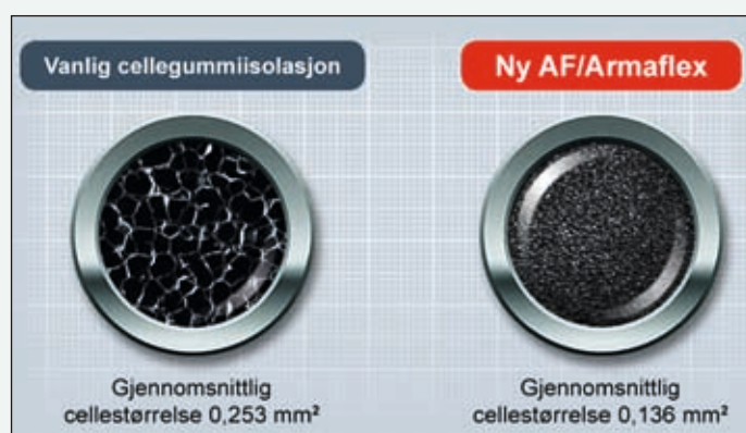
Bilde 3: For cellegummiisolasjon bygger \mu -verdien seg kontinuerlig opp med – celle for celle– over hele isolasjonstykkelsen: Den nye AF/Armaflex har rundt 734 celler per \text{cm}^2 , mens vanlig cellegummiisolasjon har rundt 400 celler.
