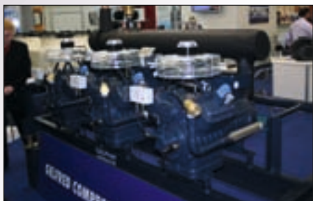
Kompressor med «eget kjøleanlegg» i form av kjølevifter.
