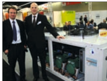
Espen E. Johansen og Mattias Taivalsaari viste en multikompressor-enhet med tre Bitzer-kompressorer, hvorav én har trinnløs regulering, mens de to andre kompressorene har step-regulering. Med en slik løsning oppnår man trinnløs kapasitetsregulering over et stort kapasitetsområde.
