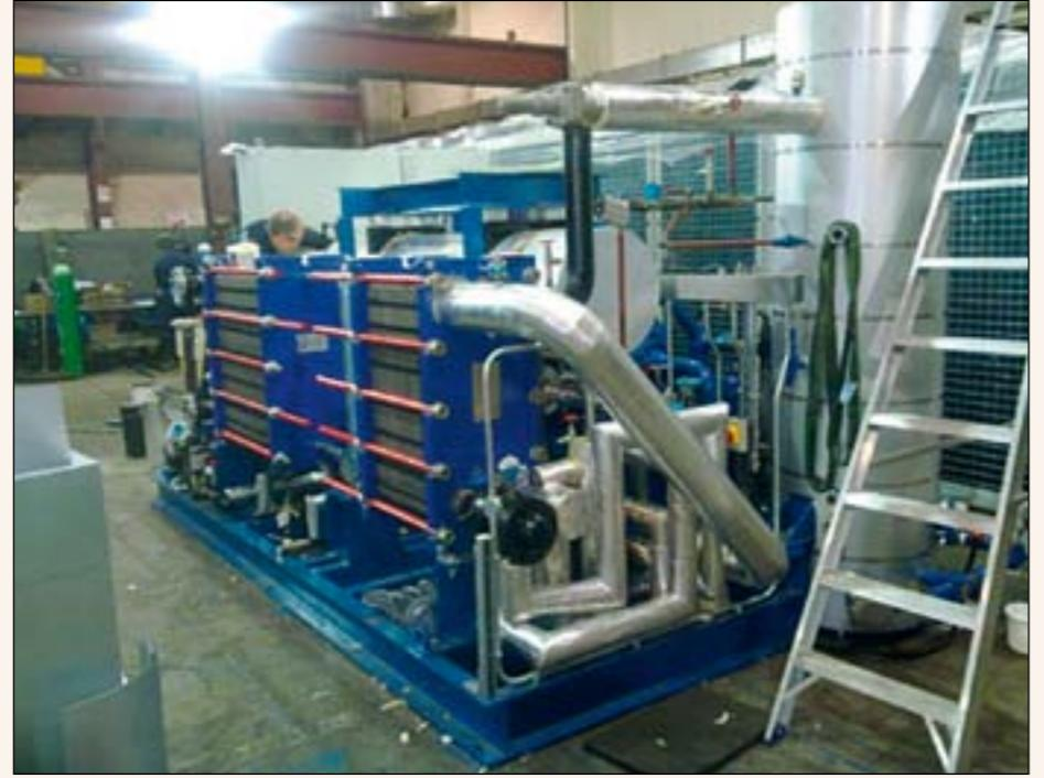
En ny varmepumpe på 560 kW er satt i drift ved Ramsund orlogsstasjon. Foto: Terje Bartholzen
