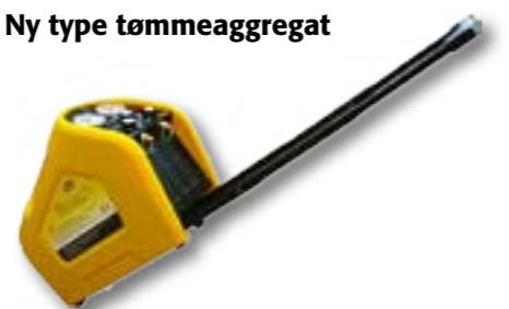
Det nye tømmeaggregatet CM 2000 er beregnet for alle HCFC- og HFC-kuldemedier, inklusivt R410A. Det tømmer kuldemedium i både gassform med 16,8 kg/h og i væskeform med 120kg/h.
