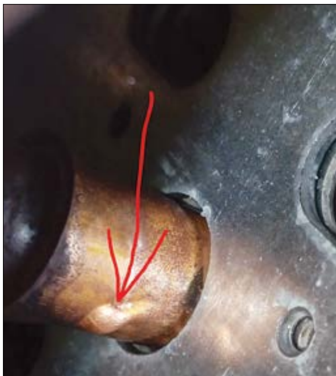
Bildet 2 viser hvordan fuktighet trenger inn i loddeskjøten og sprenger den slik at det oppstår en boble.
