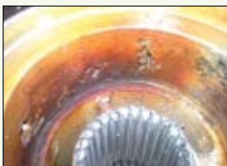
Kavitasjon i en pumpe
